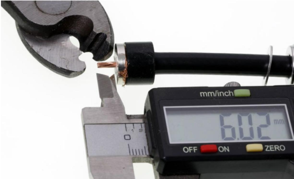
Mithilfe unserer Koaxkabelschere [KKS 16](#) wird der Innenleiter so geschnitten, dass die Innenleiterstruktur erhalten bleibt und der Mittelkontakt problemlos aufgesteckt werden kann.
